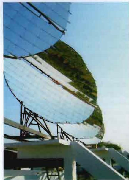
Detalle de una instalación de reflectores solares Scheffler de 10 m 2 . El acero y los espejos son los únicos materiales básicos necesarios para la construcción del reflector.
