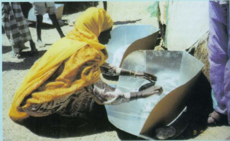
Modelo de cocina solar con un reflector de cartón forrado de aluminio y el recipiente envuelto en una bolsa de plástico para acumular el calor.
