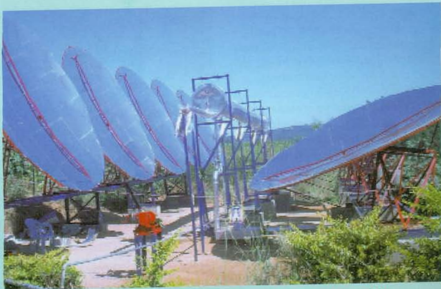
Ejemplo de aplicación de los reflectores Scheffler en una instalación comunitaria de la India.
